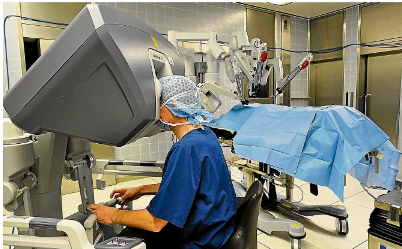
Operation per Joystick: Der Chirurg an der Steuerungseinheit lenkt jede Bewegung der feinen Metallfinger des Operationsroboters „da Vinci“, die im Hintergrund über dem OP-Tisch zu sehen sind.
