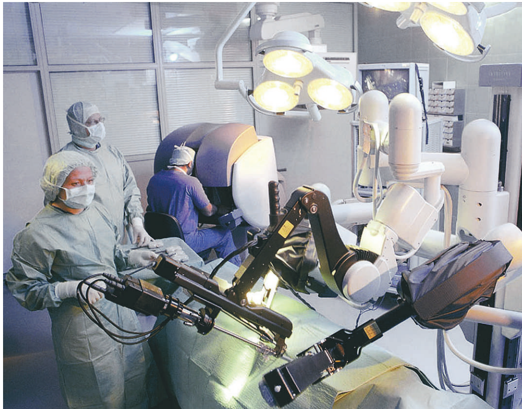
Der Operationsroboter „daVinci“ nimmt hier den Platz des Chirurgen ein. Dieser sitzt an der Steuerkonsole im Hintergrund und steuert die Arme der Maschine. FOTOS (4): INTUITIVE SURGICAL/PKN
